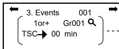
Noter que le système du contrôleur 301C/E3Point rapporte le temps depuis le dernier étalonnage en jours. Par conséquent, en fixant la limite de temps à 5 minutes pourrait provoquer l'activation d'un événement 1140 minutes (1 jour) après l'étalonnage.
